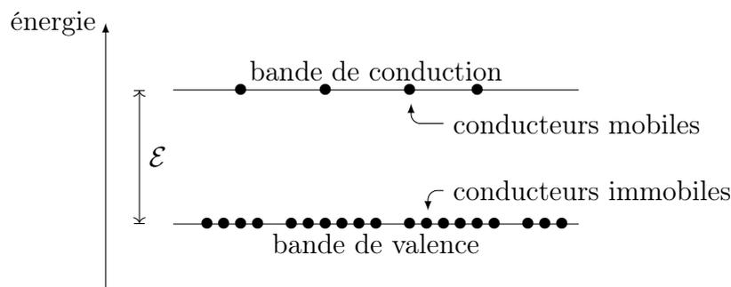
FIGURE 5 – Bandes de valence et de conduction
